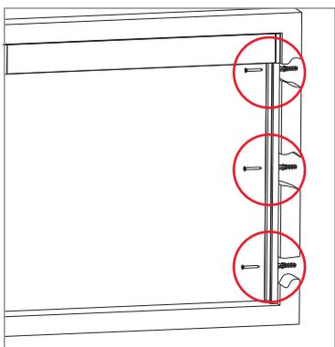
**11** Posizionare il profilo laterale e fissare praticando dei fori.
