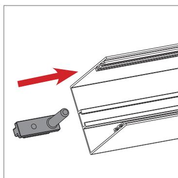
**1** Inserire la baionetta nella scanalatura della guida superiore.
