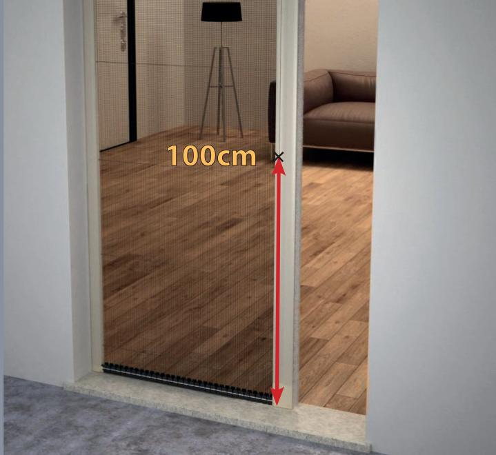
Posizionamento della vite di fissaggio
