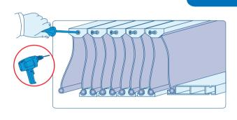
Inserire le fermacerniere ad incastro e fissarle con le viti
