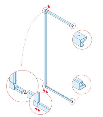
Inserire le guide, sia superiore che inferiore, nelle squadrette ad angolo del profilo laterale sinistro, montato in precedenza. Eseguire la medesima operazione anche per il profilo laterale destro.
