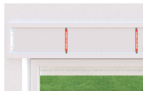
6 inserire il primo tappo e riportare i fermi in posizione di bloccaggio
